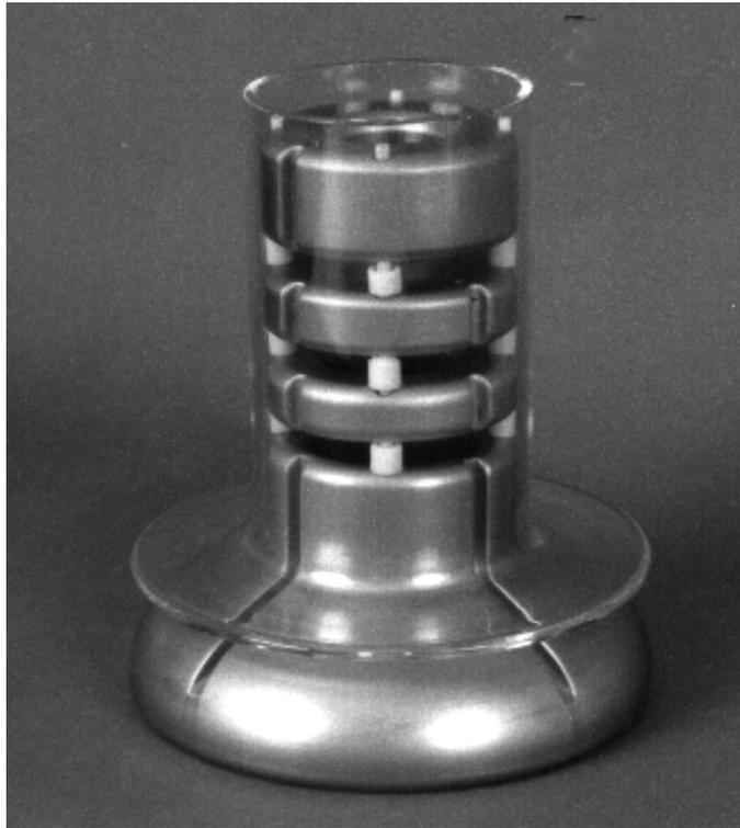
**Abbildung 4.12: Photographie der magnetischen Hochfeldelektroden E10 bis E13.** Dargestellt ist das einbaubereite System. Es fehlen nur die Spannungszuführungen (Glasröhrchen mit Draht), die in den Einkerbungen untergebracht sind.
