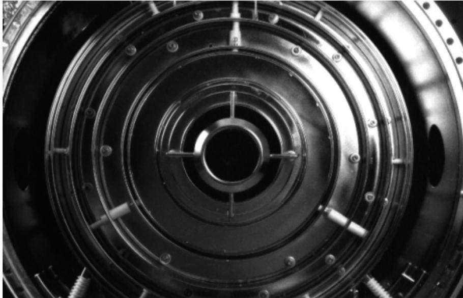
**Abbildung 4.14: Photographie des Elektrodensystems, Blick entlang der Achse des Spektrometers bei abgenommener Kuppel.** Die weißen Teile sind Keramikstücke, mit denen die Elektroden isolierend aneinander befestigt sind. Die Spannungszuführungen sind noch nicht angebracht. Ganz vorne ist die Elektrode E9 zu sehen. Zwischen dieser Elektrode und der Elektrode E10 (siehe Abb. 4.13) befindet sich kein Isolatormaterial.
