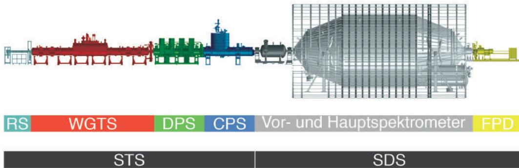
**Abbildung 3.1** Übersichtsdarstellung des über 70 m langen Experimentaufbaus von KATRIN. Der Aufbau ist in die Quell- und Transportstrecke mit der Rear Section, WGTS, DPS und CPS sowie die Spektrometer- und Detektor-Sektion mit Vor-, Hauptspektrometer und Detektorbereich unterteilt.
