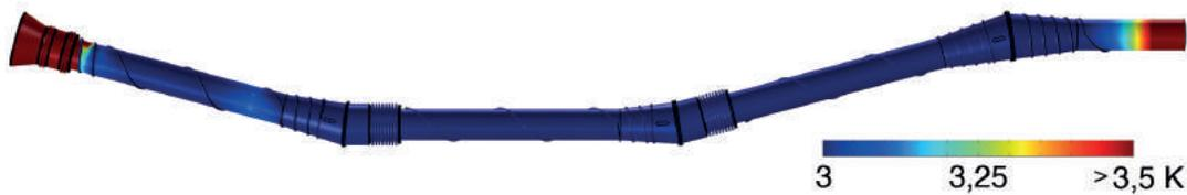
**Abbildung 5.8** Temperaturverteilung bei Simulation mit einer Umgebungstemperatur von  $T_U = 13$  K. Wie zu erkennen, ergibt sich eine äußerst homogene Temperaturverteilung, bei der die Inhomogenitäten deutlich weniger als  $\Delta T = 0,05$  K betragen.
