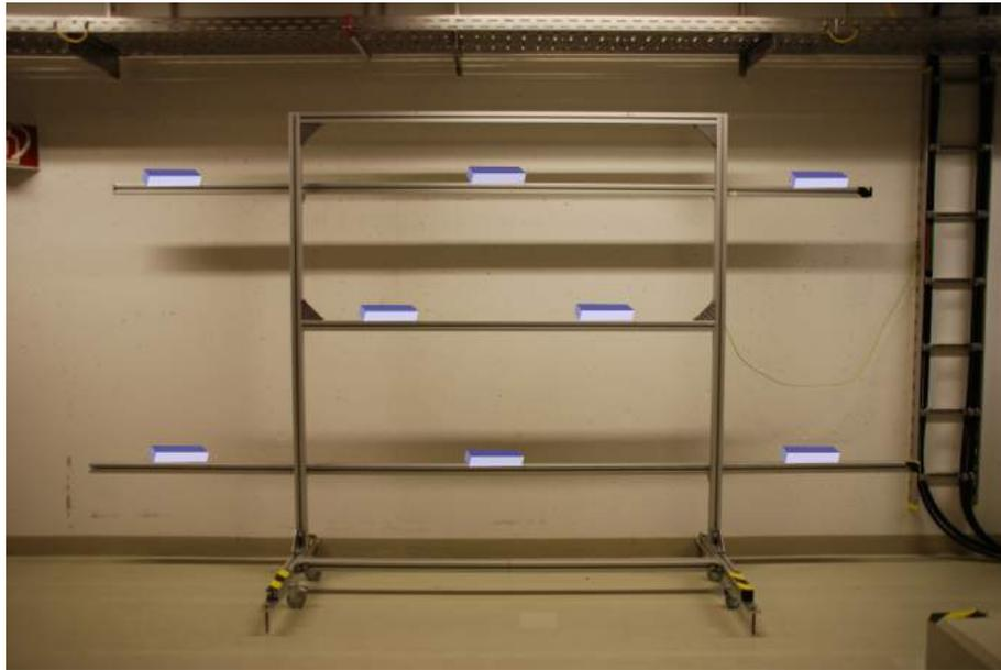
Abbildung D.15.: **Messgestell** aus Bosch Profilen. Die eingezeichneten blauen Boxen stellen die Messposition mit dem Bartingtonsensor dar.
