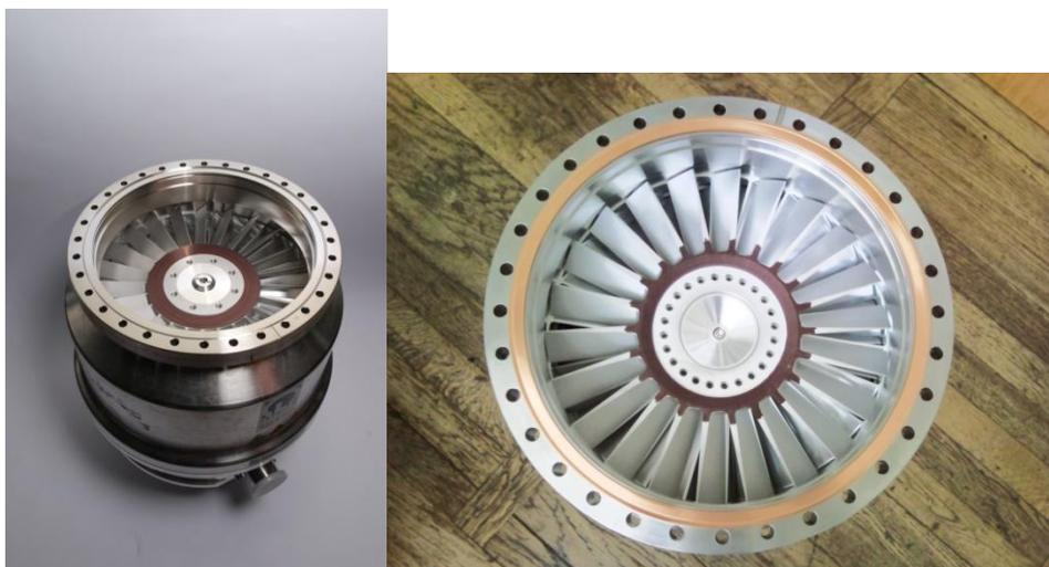
Abbildung 3.2: Links MAG W 2800 und rechts MAG W 2200 mit geschwärztem Rotor
