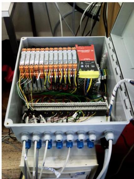
Abbildung 3.20: Aufreihung der Signalwandler für die PT100-Sensoren und der analogen Signale von Pyrometer, Gasfluss und Magnetfeld
