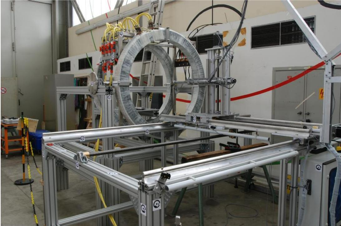
Abbildung 3.14: Im Vordergrund der Messtisch und im Hintergrund das Spulenpaar, in dessen Mitte sich gerade die Hall-Sonde befindet. [36]
