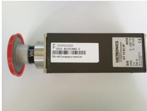
Abbildung 3.6: Das verwendete KT15.82 IIP-Pyrometer, links der KF-Flansch und rechts auf dem Deckel die Steckerverbindung zum Auslesen der Spannung
