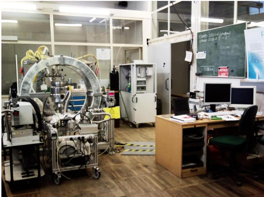
Abbildung 3.1: Überblick über den gesamten Versuchsaufbau. Links die Helmholtz-Spule mit TMP und rechts die für die Datenaufnahme verwendeten PCs.
