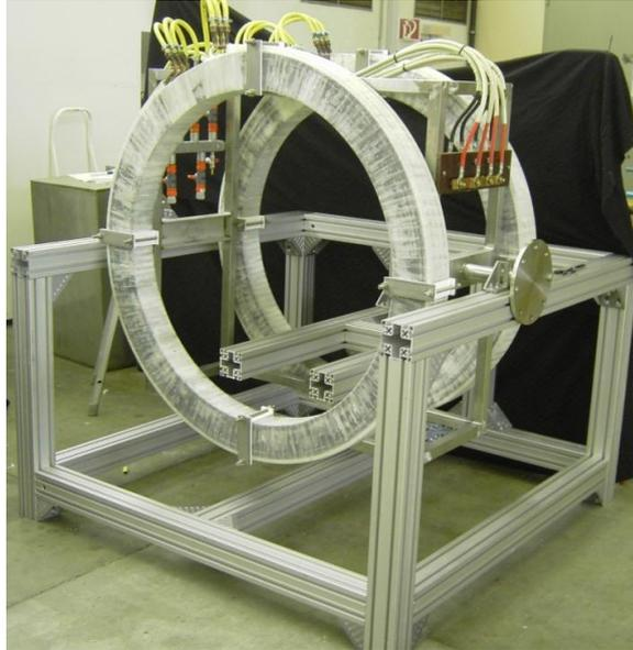
Abbildung 3.13: Das drehbare Helmholtz-Spulen-Paar hat einen Durchmesser von 120 cm und einen Spulenabstand von 60 cm
