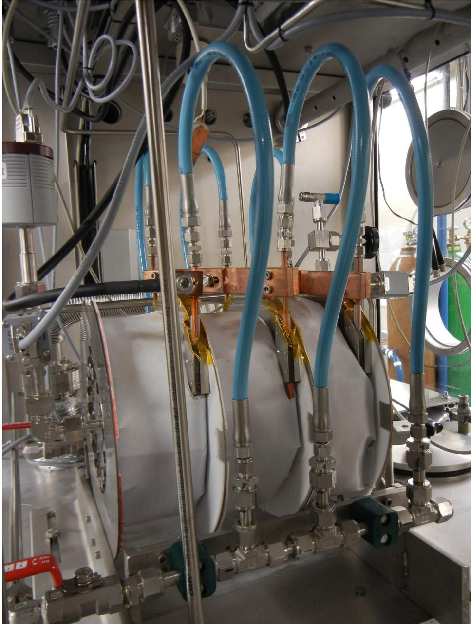
Abbildung 4.9.: Die wassergekühlte Luftspule in einer Detailaufnahme.
