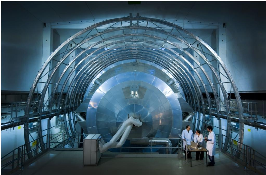
**Abbildung 2.9.: Der Hauptspektrometertank von KATRIN.** Blick aus Richtung WGTS. Die metallische Gitterstruktur trägt die Erdfeldkompensationsspulen und die Korrekturspulen für die Magnetfeldkorrektur in der Analyseebene des Spektrometers.
