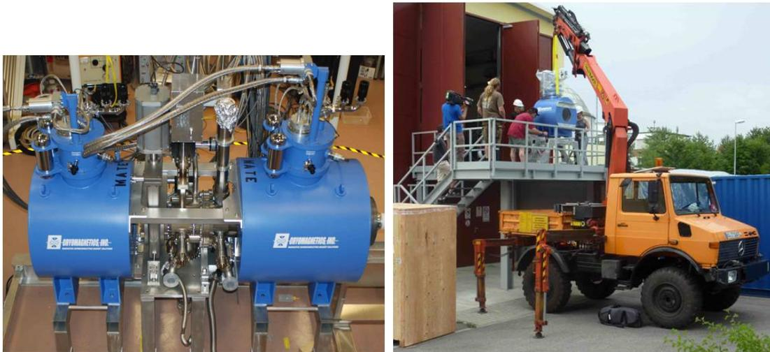
**Abbildung 2.12.:** Bilder vom Detektorsystem. Links ist das in den USA zusammengesetzte Detektorsystem zu sehen, bevor es zum KIT geschickt wurde. Der supraleitende Magnet (blau) auf der linken Seite ist der sog. Pinch-Magnet und gehört physikalisch zum Hauptspektrometer. Auf dem rechten Bild ist die Einbringung eines der beiden supraleitenden Magnete in die Spektrometerhalle dargestellt.
