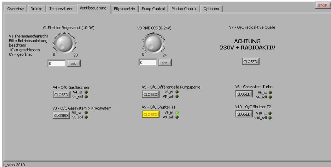
**Abbildung 5.6:** Die Ventilsteuerseite des Krypton-Steuerungsprogramms. Von hier aus können alle Ventile geöffnet und geschlossen werden. Zusätzlich werden die Lagesensoren ausgewertet sowie Soll- und Ist-Stellungen der Ventile verglichen.
