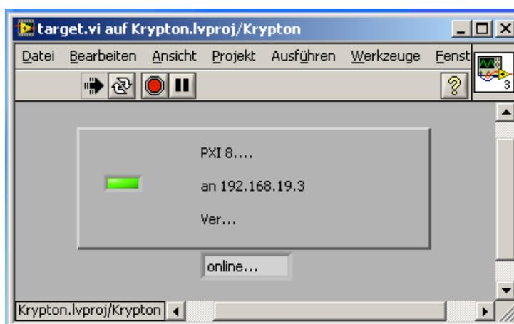
**Abbildung 5.11:** Beim „Target.vi“ handelt es sich um ein Kontroll-Programm des Datenservers. Nur durch Ausführung dieses VIs werden alle benötigten Substrukturen auf dem Real-Time Betriebssystem ausgeführt und eine korrekte Datennahme und Steuerung ermöglicht.
