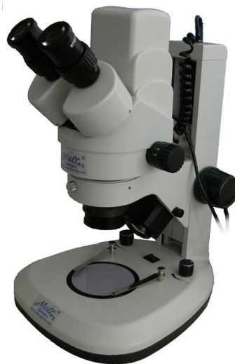
Abbildung 4.25: Fotografie des zur Untersuchung der Proben verwendeten optischen Mikroskops. Das Mikroskop ist so ausgewählt worden, dass es möglichst einfach innerhalb einer Handschuhbox bedient werden kann. Zudem kann das Mikroskop nicht nur zur Untersuchung von durchsichtigen Optiken genutzt werden, da sowohl Auflicht- als auch Durchlicht-Lichtquellen zur Verfügung stehen.
