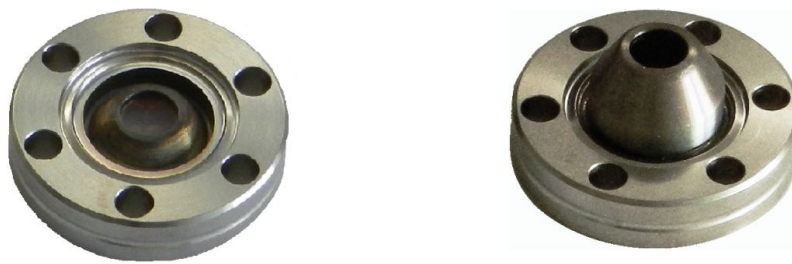
Abbildung 4.13: Fotografie eingeschweißter Laser- und Raman-Fenster. Links: Laser-Fenster. Rechts: Raman-Fenster. Beide Fenster sind so fotografiert, dass man die der LARA-Zelle zugewandte Seite sehen kann. Weiterhin wird deutlich, dass die Fenster nicht komplett sichtbar sind, sondern der Rand der konischen Einfassung diese zum Teil bedeckt. Aufgrund dieser Einfassung können die Fenster nicht gleichmäßig bis zum Rand hin beschichtet werden. Die Einfassung wirkt sich zudem in Bezug auf die Untersuchungsmethoden aus (siehe 4.5).
