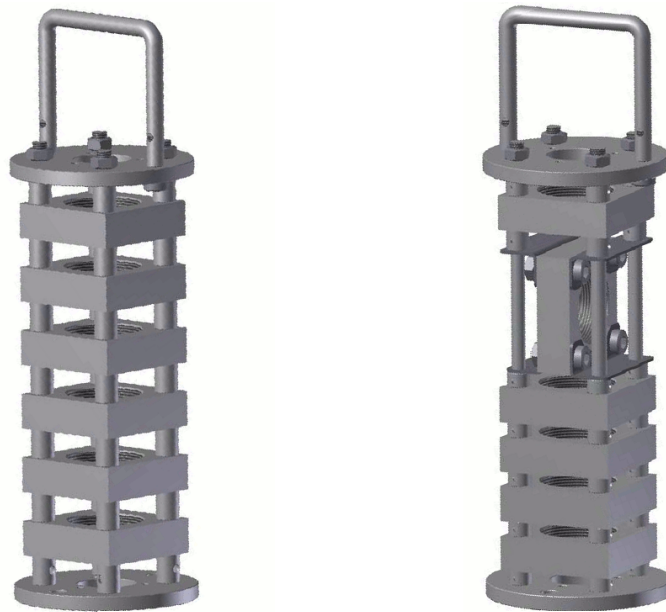
Abbildung 4.16: CAD-Zeichnung zweier unterschiedlicher Gestänge. Links: Hier ist die Art von Gestänge abgebildet, in dem alle nicht eingeschweißten Proben parallel zueinander aufgefädelt sind. Es wird im Probenbehälter I verwendet. Rechts: Man erkennt in diesem Gestänge die um 90^\circ gegenüber den anderen Proben gedrehte Probe. Diese Art von Gestänge wird in Probenbehälter III und IV verwendet.
