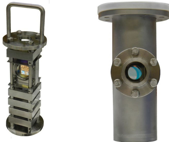
Abbildung 4.17: Fotografie eines Gestänges vor und nach Einbau in den Probenbehälter. Links: Hier ist eine Fotografie eines Gestänges mit einer um 90^\circ gedrehten Probe gezeigt. Rechts: Wird dieses Gestänge in einen Probenbehälter mit Fenster eingebaut, hat man durch die Fenster des Probenbehälters einen guten Blick auf die um 90^\circ gedrehte Probe.
