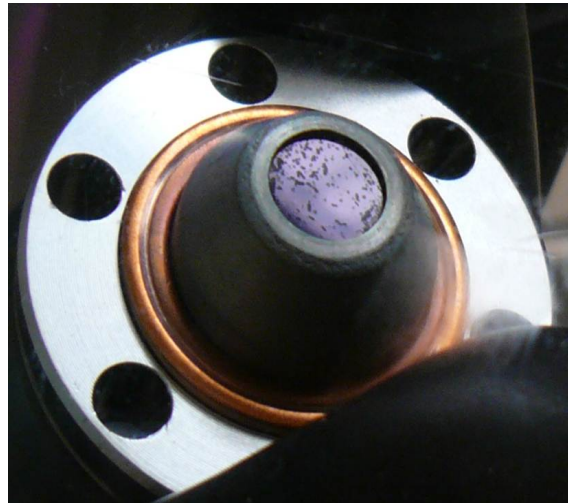
Abbildung 2.11: Fotografie eines beschädigten LARA-Fensters. Gezeigt ist ein Fenster, durch das das gestreute Licht aus der Zelle entnommen wird. Die Beschädigung ist mit dem bloßen Auge erkennbar. Sie zeigt sich in Form dunkler Flecken auf der Oberfläche der Innenseite der Fenster.
