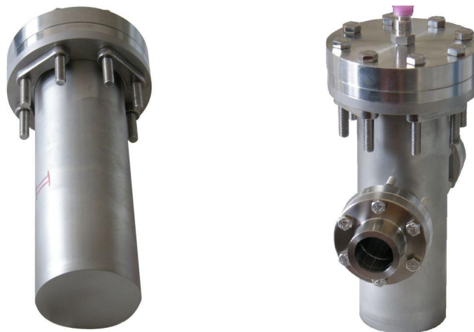
Abbildung 4.15: Fotografie der beiden Probenhalterungen. An beiden abgebildeten Probenbehältern ist noch kein Handventil angebracht. Links: Probenbehälter, der aus einem CF63-Rohrstück gebaut worden ist. Die untere Rohrseite ist zugeschweißt worden, um Gewicht zu sparen. Rechts: Probenbehälter, der aus einem CF63-Kreuzstück gefertigt worden ist. Auch hier ist der Boden zur Gewichtsreduktion verschweißt worden. An den kleineren CF40-Rohren sind Titan-Saphir-Fenster verbaut. Die Probenentnahme geschieht bei beiden Behältern über den an der Oberseite sichtbaren Flansch.
