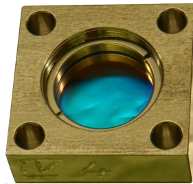
Abbildung 4.3: Fotografie einer von der Firma LASEROPTIK mittels EBD beschichteten Probe. Die gezeigte Probe ist in die Probenhalterung eingefasst. Die Strukturen innerhalb des Fensters rühren von der Unterlage her, auf der die Probe während des Fotografierens lag.
