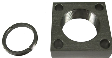
Abbildung 4.1: Fotografie der Probenhalterung und eines zugehörigen Sicherungsringes. Auf der linken Seite ist ein Sicherungsring zu sehen, auf der rechten die Probenhalterung. Beide Komponenten verfügen über ein Feingewinde, welches eine sichere Einfassung der Proben in die Probenhalterung ermöglicht. Die Probe wird mit je einem Sicherungsring auf jeder Seite in die Probenhalterung eingefasst.
