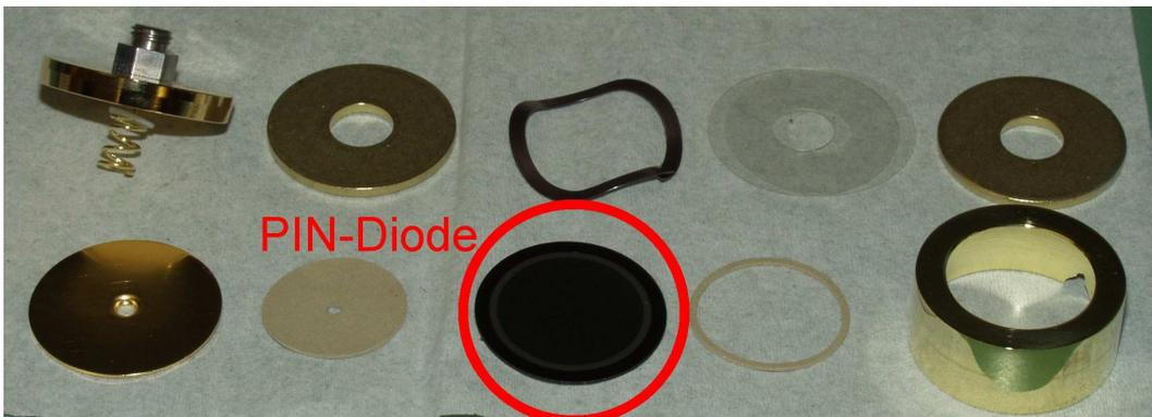
**Abbildung 3.8:** ORTEC PIN-Diode Typ BU-014-300-500. Neben der ORTEC PIN-Diode sind Teile der mitgelieferten Halterung zu sehen, die wegen zu großer Mikrofonie nicht verwendet werden konnten.
