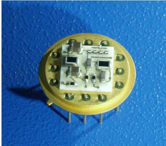
**Abbildung 3.12:** Die unmittelbar beim Detektor angebrachte erste Vorverstärkerstufe, der IPE-316/4/6 Front End Hybrid.
