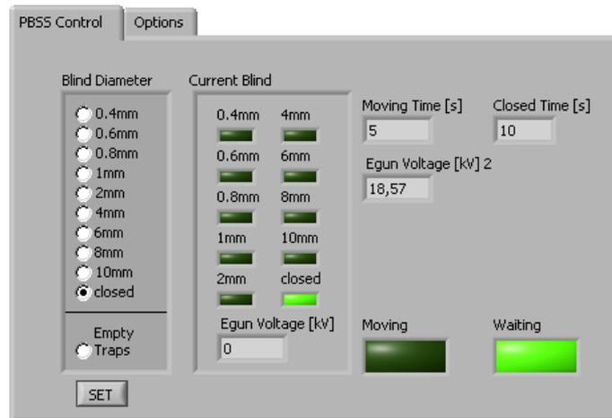
**Abbildung 3.9: Benutzeroberfläche der Ansteuerungssoftware des PBSS.** Es sind verschiedene Blendendurchmesser und das entleeren von Elektronenfallen einstellbar.
