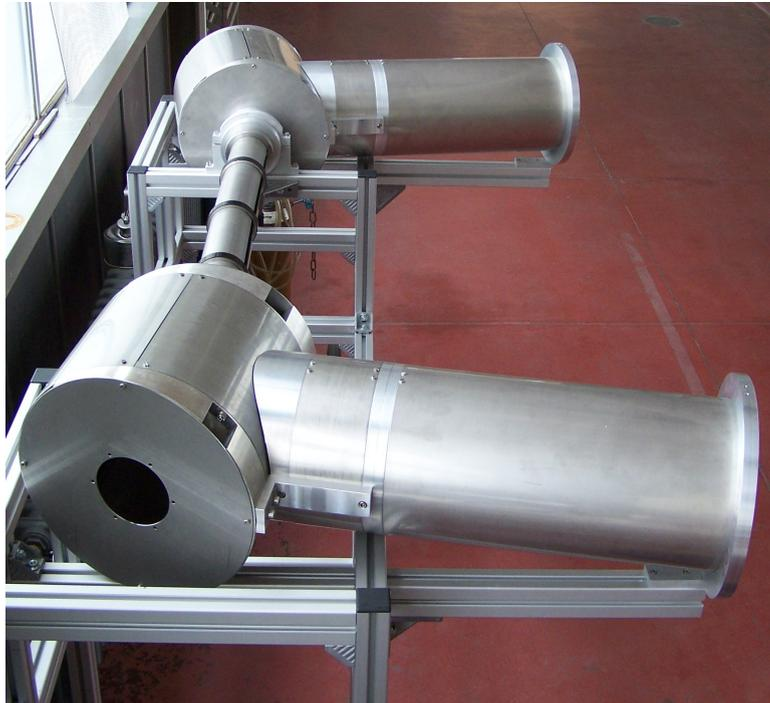
**Abbildung 6.4:** Modell des Strahlrohres mit angrenzenden Pumpports
