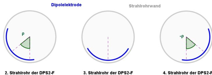
**Abbildung 5.17:** Drehung der Dipole in den drei Strahlrohren um die Effektivität der Ionen Elimination zu erhöhen
