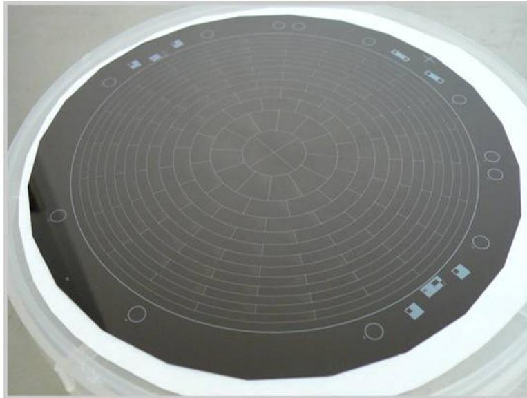
**Abbildung 2.15:** Detektor mit segmentierter Oberfläche aus 148 flächengleichen Pixeln, radial verteilt auf 12 Ringe. Damit können die Spektren nach ihrer Herkunft aus der Quelle aufgenommen werden und systematische Effekte untersucht werden. Bild entnommen aus [10].
