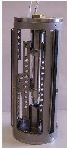
**Abbildung 6.2:** Rohrgreifer für die Installation der Dipolrohre in die DPS2-F
