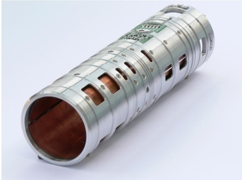
**Abbildung 3.3:** FT-ICR Analyse Gerät für das KATRIN Experiment. Entwickelt von Stefan Stahl.
