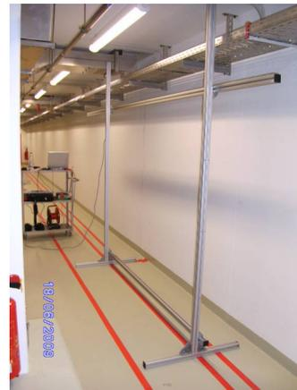
**Abbildung 4.2:** Aufbau der Messapparatur während der Magnetfeldmessung an den Wänden der KATRIN Halle
