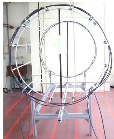
**Abbildung 5.1:** Foto des Monitorspektrometers EMCS Aufbaus
