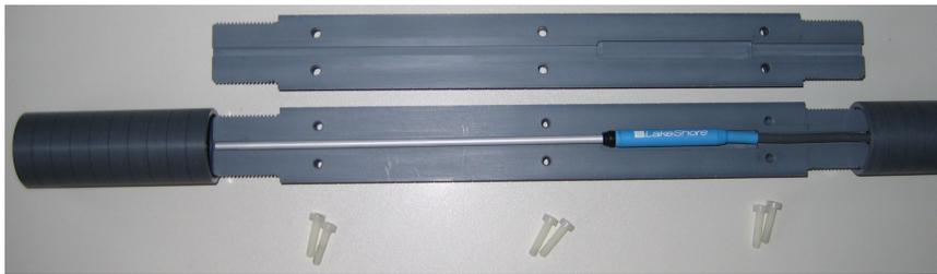
**Abbildung 6.3: Halterung für den Sensor** – In einer Halterung aus PVC befindet sich ein Hall-Sensor. Die Halterung kann in ein Rohr eingeführt werden, um den Verlauf der magnetischen Flussdichte entlang der Strahlrohrachse zu messen.
