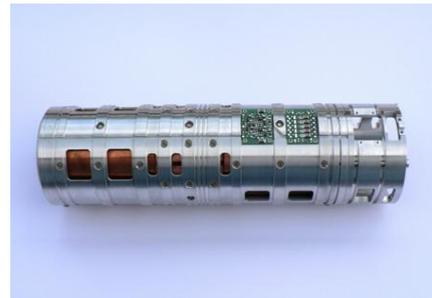
**Abbildung 2.4: Dipol (links) und FT-ICR Modul (rechts)** Die Instrumentierungen werden im Strahlrohr der DPS2-F angebracht. Quellen: [Win10] [Dia10]
