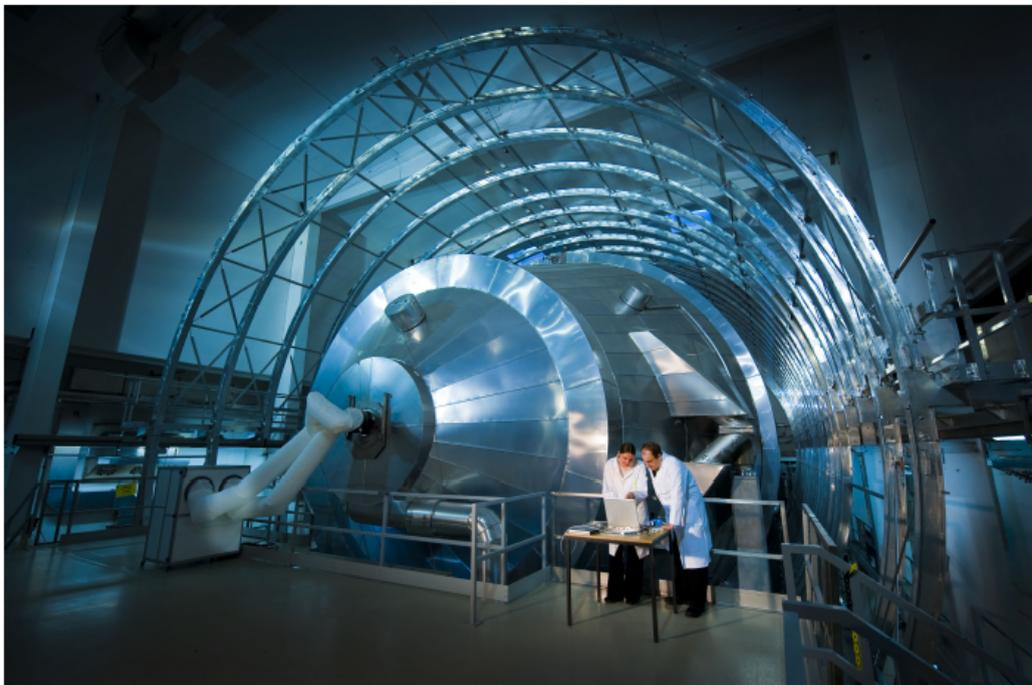
Abbildung 2.10: Foto des KATRIN Hauptspektrometers mit Luftspulensystem.
