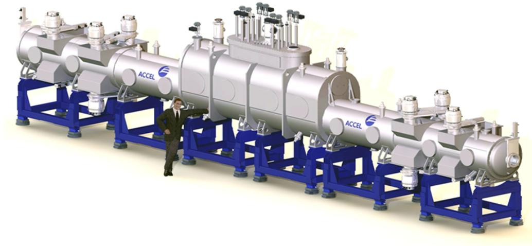
Abbildung 2.3: Der WGTS-Kryostat: Ansichtszeichnung der ACCEL Instrum. GmbH.
