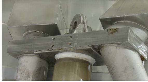
**Abbildung 5.8.:** Foto des Auflagepunktes des Hauptspektrometertanks auf den Stützen. Siehe auch Abbildung 3.1 oben mittig.
