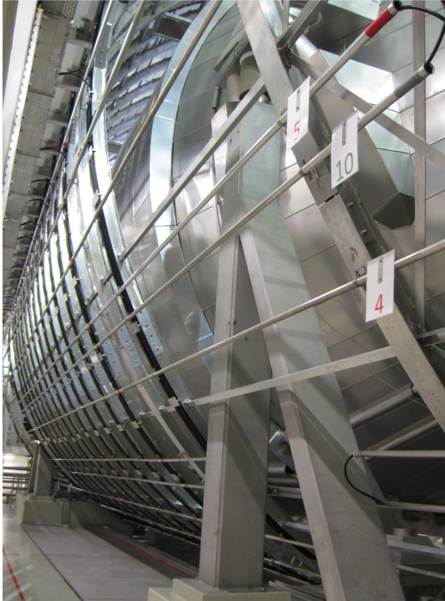
**Abbildung 3.1.:** Foto des Luftspulensystems. Das Bild zeigt das Hauptspektrometer und das Luftspulensystem von der Westseite in Blickrichtung entlang der Strahlachse, aufgenommen aus dem Untergeschoss. Zu sehen sind die Aluminiumringe, welche die LFCS-Kabel tragen und die Rohre, in denen die EMCS-Kabel geführt werden. Im Vordergrund ist die Beschriftung der EMCS-Leiterschleifen zu sehen.
