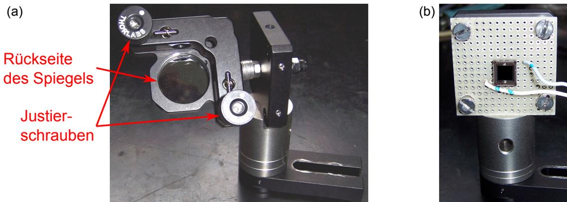
**Abbildung 3.7.:** a: Foto des Spiegels von hinten und der verwendeten Halterung. An den Justierschrauben lässt sich der Spiegel in zwei Achsen verkippen. b: Foto der UV-Diode, die zur Befestigung auf ein Stück Lochrasterplatine gelötet wurde.
