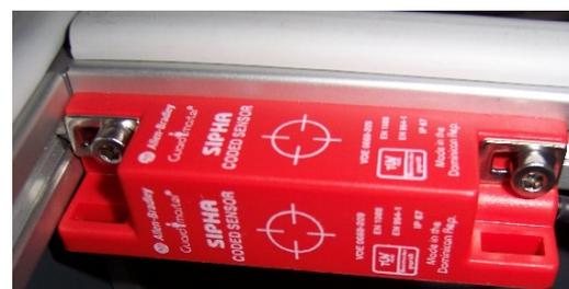
**Abbildung 3.6.:** Foto der Bedienoberfläche des Interlocksystems (a). Über die beiden Schalter kann der Shutter geöffnet oder geschlossen werden. Die vier LEDs geben eine Rückmeldung über den Zustand des Systems. Der Shutter kann nur geöffnet werden, wenn der Deckel der Laserbox korrekt aufgesetzt wurde. Dies wird durch zwei Paare magnetischer Schalter (b) sichergestellt.
