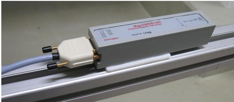
**Abbildung 5.2.:** Abbildung des Fluxgate-Magnetometers. Der Sensor ist auf einen Gleiter aus Plastik geschraubt, der entlang einer Boschprofilstange verschoben werden kann. Der serielle Datenanschluss ist links zu sehen.
