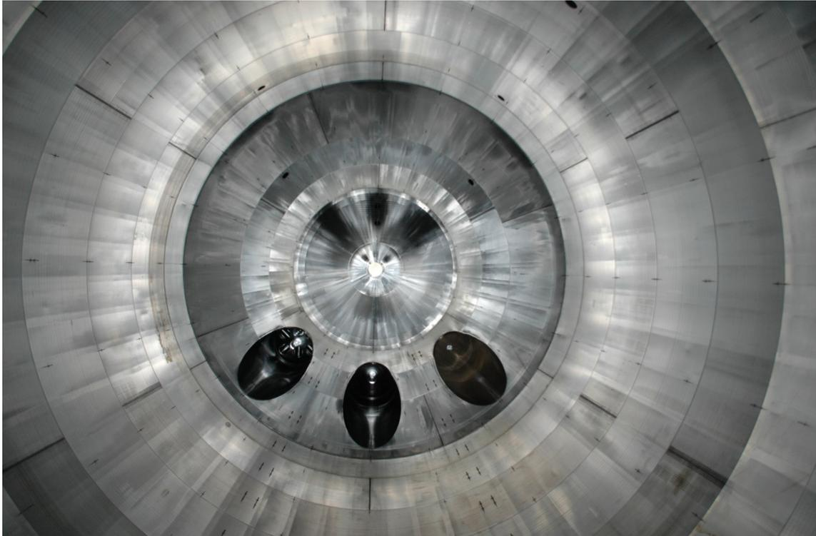
Abbildung 2.3: Innenansicht des KATRIN Hauptspektrometers vor dem Einbau der Drahtelektrode. Im Zentrum sieht man die 500 mm große Öffnung der Strahlführung. Im unteren Bereich sind drei große Öffnungen zu erkennen, in die Volumengegetterpumpen eingebracht werden.
