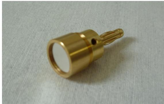
Abbildung 4.3: **Kalibrationsquelle.** Das Bild zeigt die Festkörperquelle, eingesetzt in ein Quellgehäuse.
