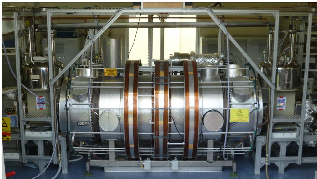
Abbildung 4.1: **Aktueller Aufbau des Monitorspektrometers.** Von links nach rechts: Quellsektion, Quellsolenoid (olivgrün) und Kühlmittelbehälter aus Edelstahl, Spektrometertank und Luftspulen, Detektorsolenoid und Vorratsbehälter für Kühlmittel, Detektorsektion.
