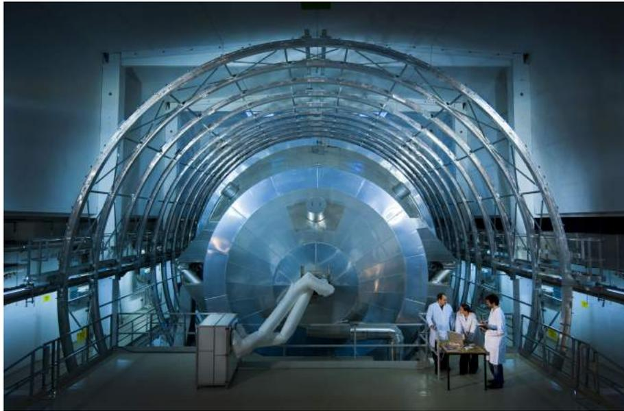
Abbildung 3.3.: **Hauptspektrometer mit Luftspulensystem.** Bild entnommen aus [Sch14b]
