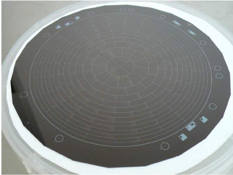
Abbildung 4.7.: **Wafer.** Zu sehen ist die segmentierte Seite des Wafers mit 148 Detektor-Segmenten. Foto entnommen aus [Wal13]
