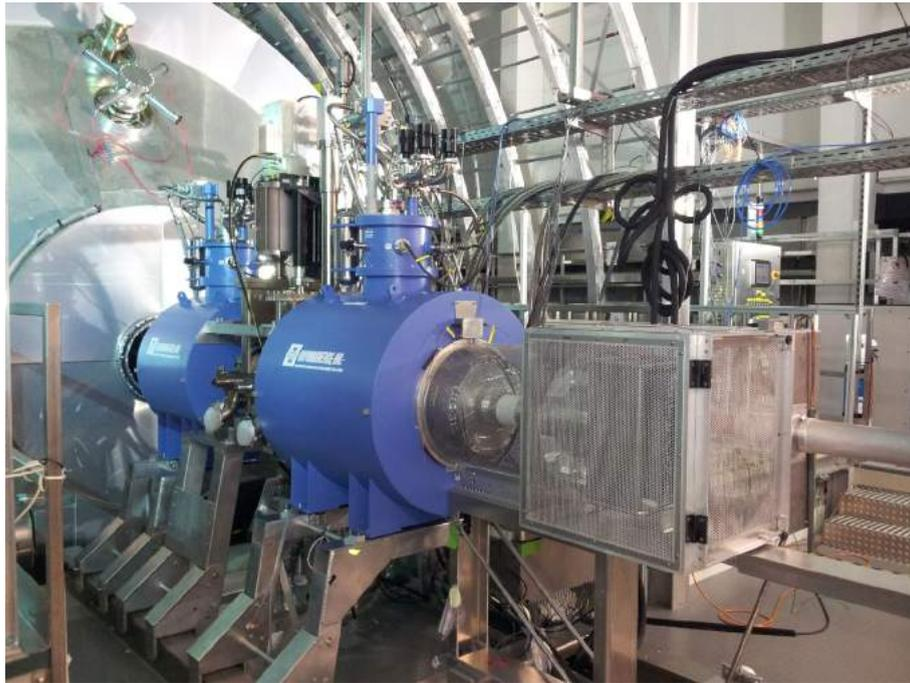
Abbildung 3.4.: **Fokalebeneendetektor-System in der KATRIN Experimentierhalle**. Auf diesem Bild sind die Schienen zu erkennen, auf denen das FPD-System steht. Zum Zusammenschluß mit dem Spektrometer kann das FPD-System auf den Schienen in dessen Richtung geschoben und anschließend mit diesem verbunden werden. Zum Zeitpunkt der Aufnahme war der Detektor nicht an das Hauptspektrometer angeschlossen. Das Foto wurde [Har12] entnommen.
