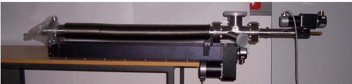
**Abbildung 3.1:** Bild des Manipulators im Ausgangszustand inklusive beider Schrittmotoren und Drehgeber [Sch08]
