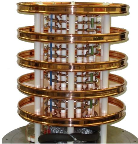
Abbildung 3.5: **Innenansicht des KATRIN 35 Hochspannungsteilers.** Die vier Ebenen des Spannungsteilers sind durch fünf Kupferelektroden getrennt. Im Inneren befindet sich eine Kette von Präzisionswiderständen. Verbunden werden die Elektroden durch Hochspannungswiderstände (blau) und Hochspannungskondensatoren (grün). Abbildung aus [Thü07]
