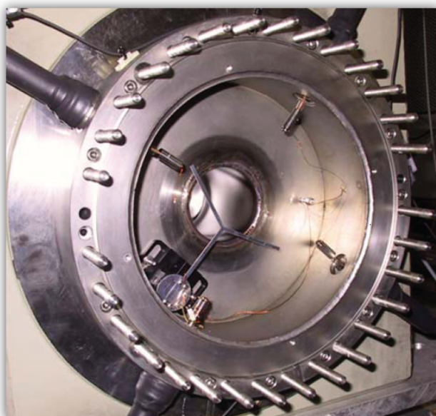
Abbildung 3.8: Position und Abbildung des Beam Profile Scanners. Der rechts abgebildete y-förmige Beam Profile Scanner, der zur Positionierung der Quelle verwendet wird, befindet sich im Flansch zwischen Quellmagnet und Spektrometer. Er besteht aus einer Metallgabel, montiert auf einem Piezomotor.
