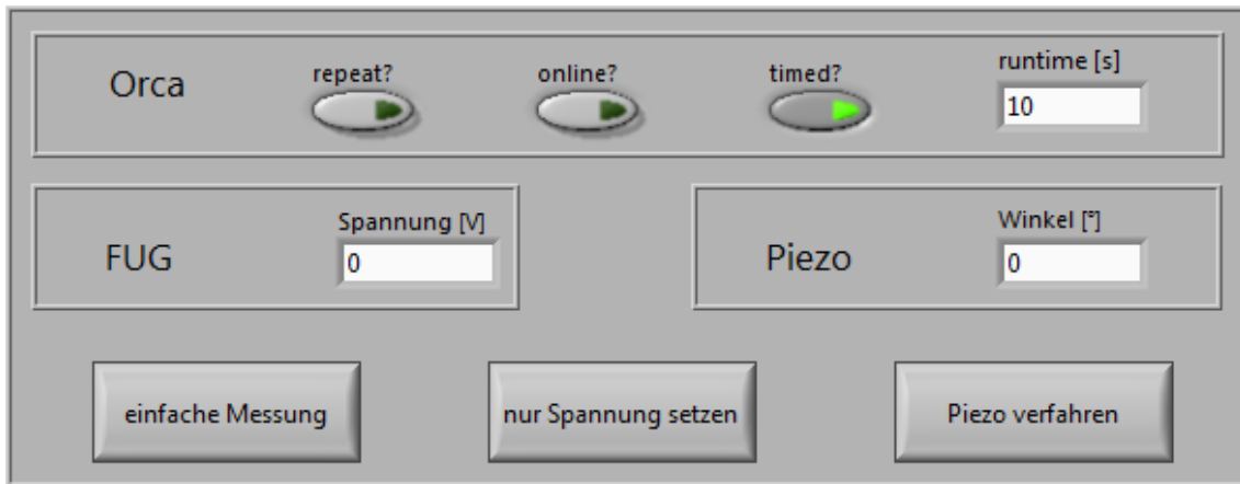
Abbildung 4.4: Bedienoberfläche der "einfachen Messung" . Zu sehen sind einzelne Bedienelemente zur direkten Steuerung von Orca (wiederholende Messung, Speichern der Messwerte, Zeitsteuerung und Messzeit), dem FUG-Spannungsgerät (Spannung) und dem Piezomotor (Winkel). Sowie Schaltelementen zum Starten der einfachen Messung und zum setzen von einzelnen Spannungs- und Winkelwerten.
