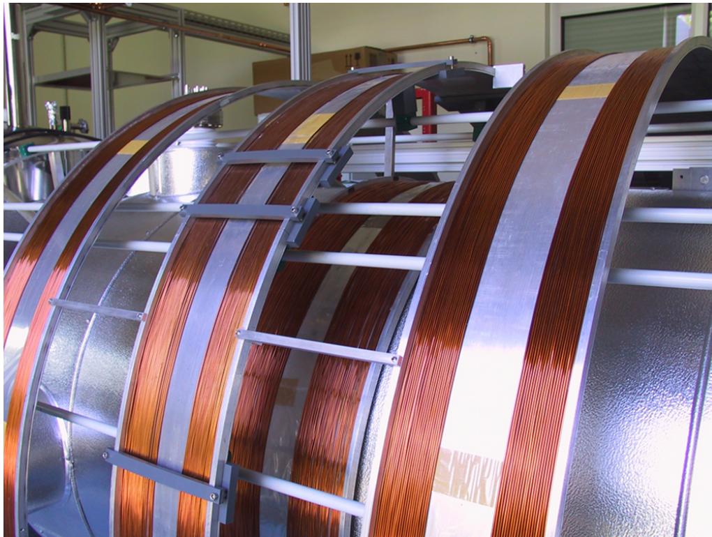
Abbildung 3.3: Luftspulensystem am Monitorspektrometer. In diesem Bildausschnitt des Monitorspektrometers, der den Bauch des Spektromertanks zeigt, sind die 4 Luftspulen der LFCS (der Kupferdraht auf der Aluminiumführung) und der, in PVC-Rohren verpackte, horizontal verlaufende Anteil des EMCS zu sehen.
