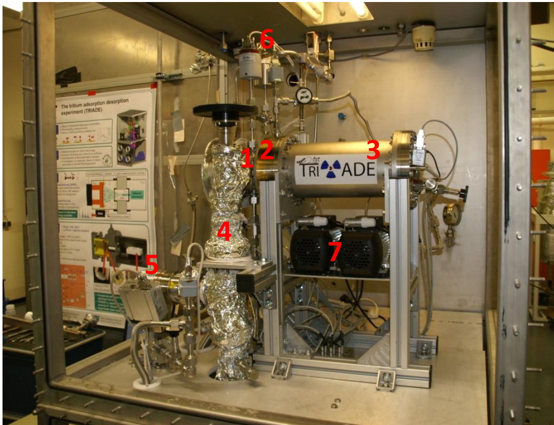
Abbildung 4: Das TRIADE Experiment. Das Bild zeigt die wichtigsten Komponenten des TRIADE Experiments. Folgende Komponenten sind abgebildet: (1) Rezipient, (2) Zwischenflansch, (3) Detektorelektronikvolumen, (4) Volumen des Massenspektrometers, (5) Leybold SL80 Turbomolekularpumpe, (6) Druckinstrumentierung und (7) Divac 0.8T Vakuumpumpen. Im unteren Teil der Handschuhbox, der nicht abgebildet ist, befindet sich Infrastruktur, wie weitere Pumpen und ein Pufferbehälter. Abbildung B.2 zeigt die gesamte Handschuhbox.
